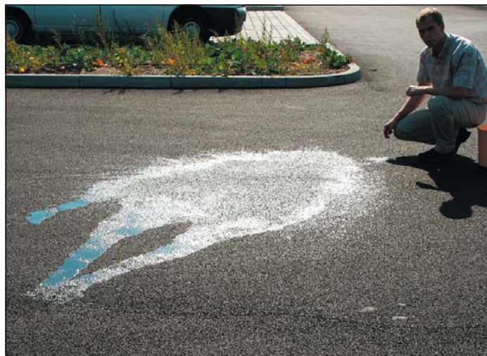
Abb. 12: Unmittelbar nach dem Ausgießen ist das Wasser fast vollständig in der Asphaltbefestigung versickert
